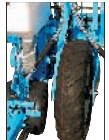
Ruedas portadoras regulables en altura
