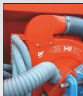
Montage du collecteur sur turbine Df
